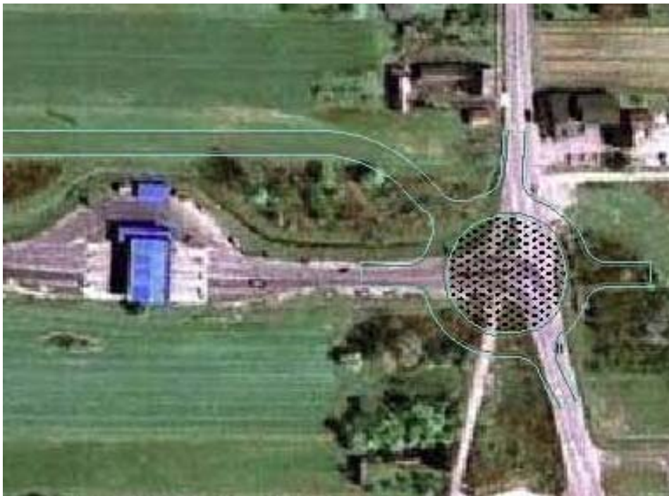
Idejno rješenje planiranog rotora na križanju Ž3159 i D36
